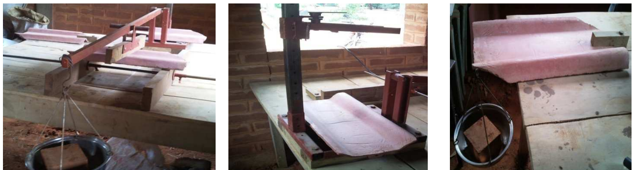
Figure 6 : photos des essais de résistances mécaniques (flexion, chocs et traction du talon).
